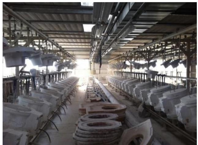
Il corpo **C**, utilizzato come deposito di prodotti finiti ha caratteristiche costruttive simili a quelle del corpo **A**, con struttura portante in c.a. precompresso e copertura costituita da travi reticolari in ferro e tegoli prefabbricati in cemento-amianto. La pianta non è completamente libera, ma presenta partizioni in c.a. a mezza altezza che delimitano sezioni di deposito.
